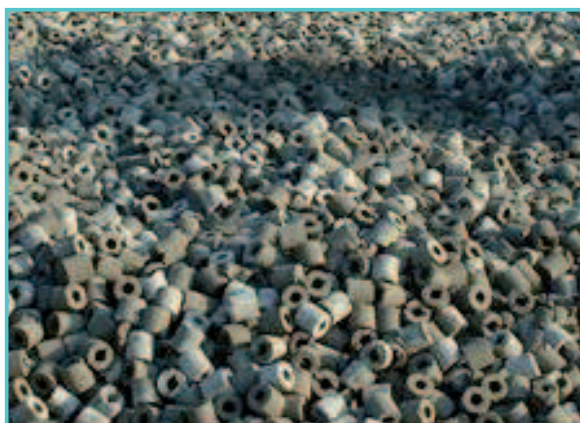
Cylindres béton creux. Porosité 60%
