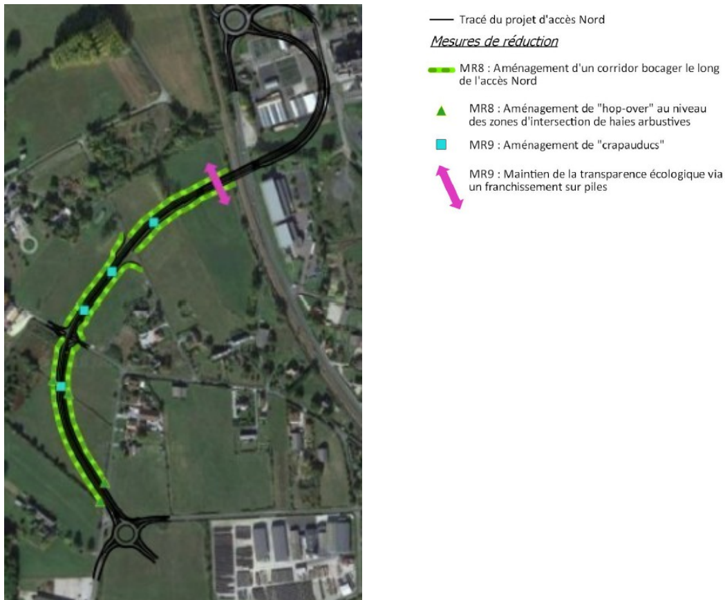
Figure 4 : localisation des corridors de haies, des crapauducs et de la transparence écologique
